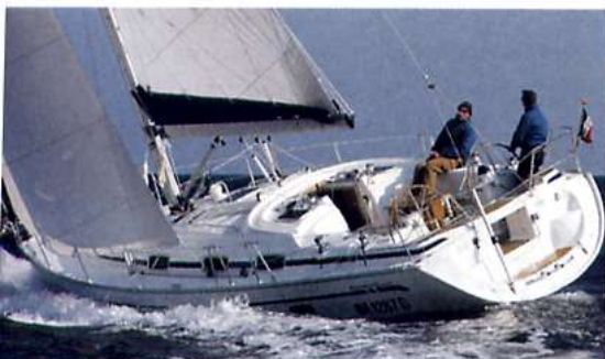
Il buon assetto consente un trascinamento limitato di acqua da parte della poppa.
