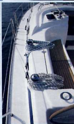
Sopra, l'attacco delle sartie interno libera da ingombri il passaggio verso la prua.
