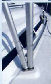
Sopra, l'attacco delle sartie interno libera da ingombri il passaggio verso la prua.
